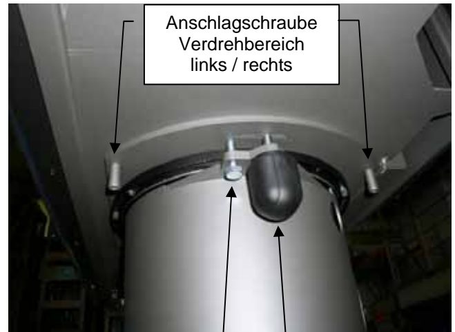
Transportsicherung / Verdreh-sicherung. Nach dem Aufstel- len entfernen
